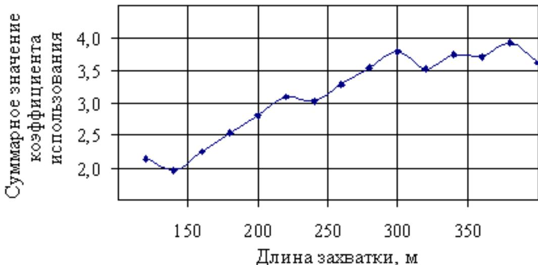
Рисунок 3 – Зависимость суммарного значения коэффициента использования всех машин от длины захватки
