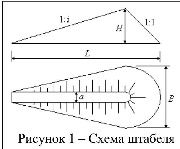
Исходя из размещения требуемого объема материала, назначают геометрические параметры штабеля таким образом, чтобы коэффициент крутизны заложения наклонной площадки находился в интервале от 4 до 6.
